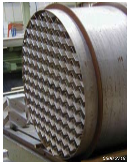
Смеситель-реактор SMV™ прямого хлорирования этилена в жидкой фазе
